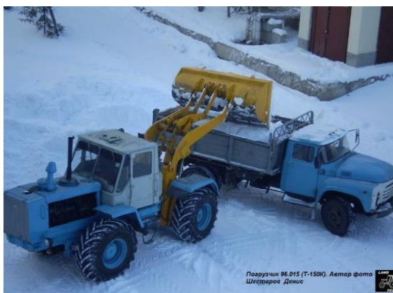
1.5 сурет - Т-150К тракторы базасында жақты қармағышты бір шөмішті тиегіштің жұмыс барысындағы көрінісі
